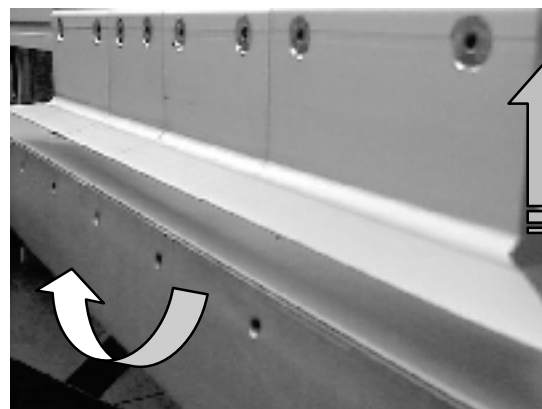
Stap 4 Bovenbalk openen Onderbalk compleet naar boven zwenken
