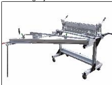
K1-AGNU-2 met dwars- en schuin snijd-inrichting K1-QSSE 30° of 45°
